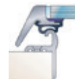
Profilé avec rebord de 25mm
